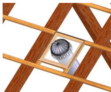
Figure 5 – utilisation des lattes auxiliaires
